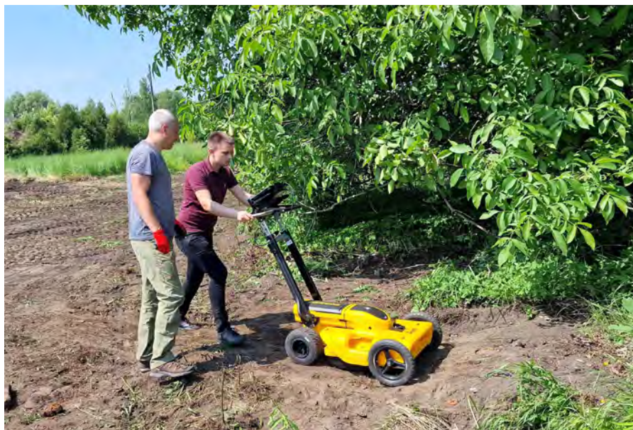
Prace poszukiwawcze z użyciem georadaru
